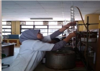
Proses distilasi (isolasi) minyak atsiri
