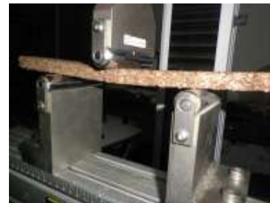
Pengujian kekuatan lentur kering
