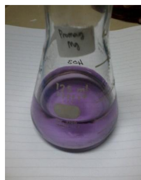
Larutan (ekstrak+buffer ph10+TEA+EDTA) setelah titrasi dengan EDTA berwarna biru, menandakan terdapat kandungan Mg
