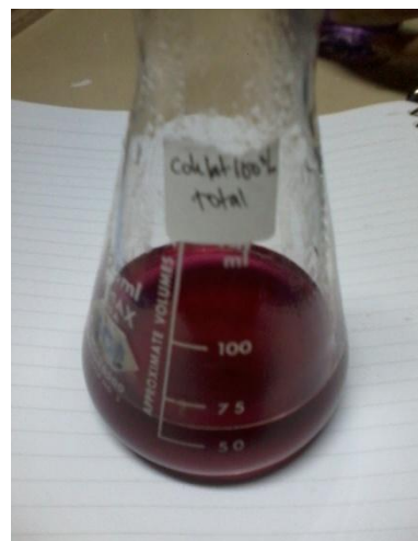
Larutan (ekstrak+buffer ph5+EDTA) setelah titrasi dengan ZnSO 4 berwarna merah terang, menandakan terdapat kandungan Al
