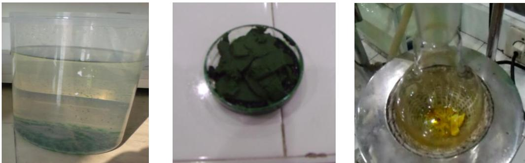
**Gambar 2. Setelah di Flok (kiri), setelah dikeringkan (tengah), dan proses ekstraksi kandungan minyak (kanan)**
