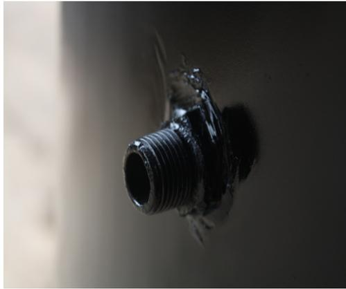
Gambar 4 Lubang Udara di Badan Kiln
