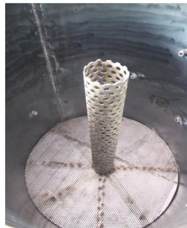
Gambar 6 Lubang Udara Bawah
