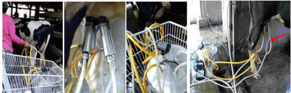
Gambar 2. (a) Alat perah sederhana (1 buah carrier , 1 unit pompa vacuum , 1 unit wadah penampung susu kapasitas 20 liter, 1 set selang susu, 4 buah tabung penyedot susu); (b) Alat perah sederhana saat proses pemerahan (selang dari tabung penyedot sudah transparan)
