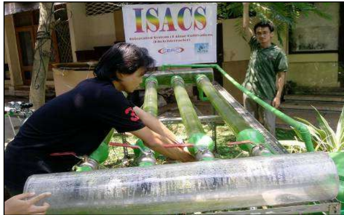
Gambar 5. Rancang bangun fotobioreaktor ISACS dilengkapi sensor dan aliran gas CO 2 .
