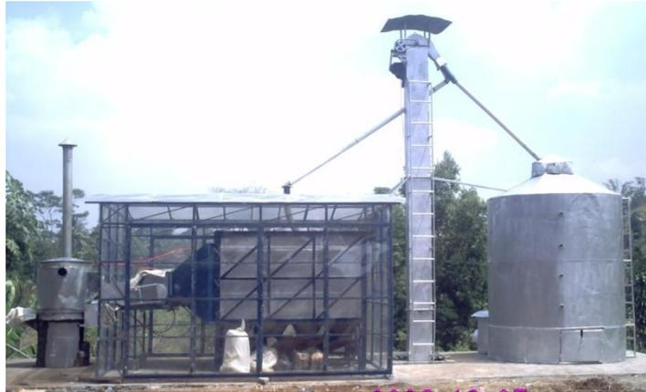
Gambar 3. Instalasi mesin pengering ERK-hybrid di Incubator Merak.
