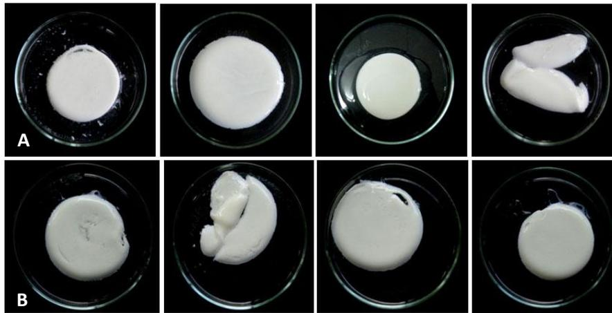
Gambar 3. Hasil uji koagulasi susu menggunakan *rennet* segar (A) dan *rennet* yang telah disimpan beku (B) dari sampling sebelumnya.
