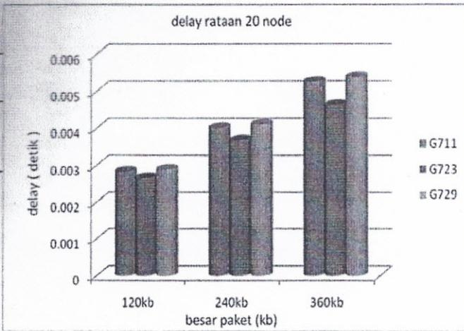
Gambar 6. Delay rata-rata untuk skenario simulasi 20 node.
