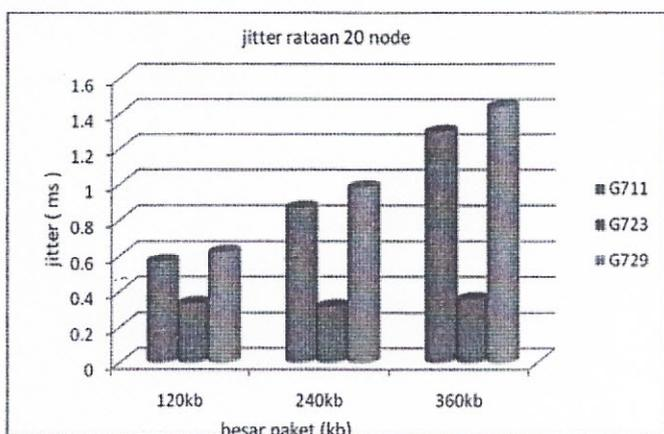
Gambar 11. *Jitter* rata-rata untuk skenario simulasi 20.
