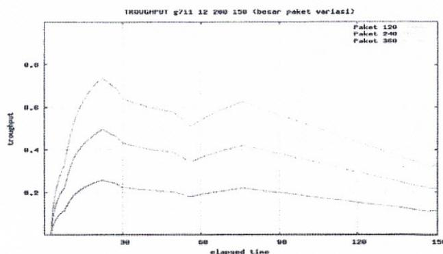
Gambar 12. *Troughput* untuk skenario 12 *node* *codec* G711.
