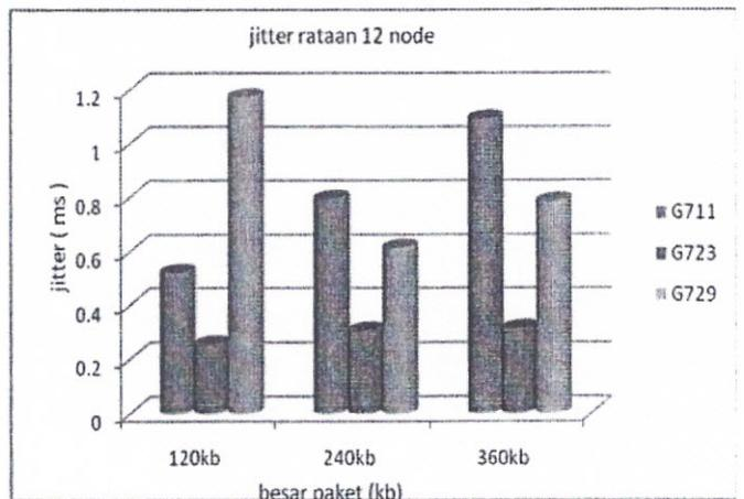
Gambar 8. *Jitter* rata-rata untuk skenario simulasi 12 node.
