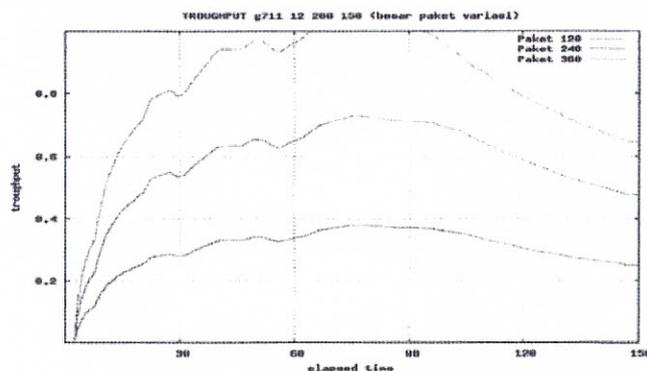
Gambar 13. *Troughput* untuk skenario 24 *node* *codec* G711.
