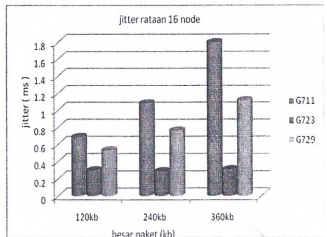
Gambar 9. *Jitter* rata-rata untuk skenario simulasi 16 node.
