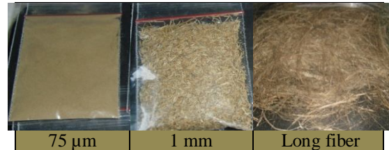
Gambar 2 Tahapan milling selulosa kulit rotan.
