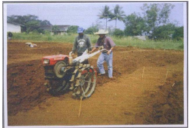
Gambar 5. Tipe-Tipe Roda Besi Yang Diuji
