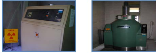
Gambar lampiran 1. Sterilisasi Bahan Pembawa dengan Metode Gamma Irradiation Co-60
