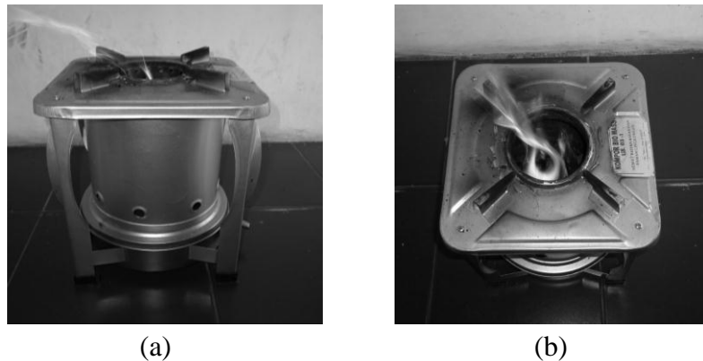
Gambar 8. Model Nyala Api Biopelet pada Kompor Biomassa (a) Tampak depan; (b) Tampak atas
