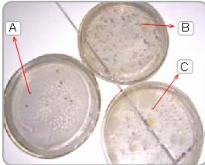
Gambar 9 Contoh hasil uji laboratorium ALT dari sampel air minum isi ulang pada DAM (A = 1,0 \times 10^1 koloni/ml, B = 5,9 \times 10^3 koloni/ml, C = 7,8 \times 10^3 koloni/ml)
