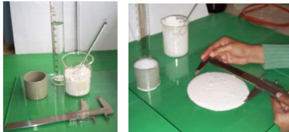
Gambar 13 Uji lignosulfonat sebagai pendispersi pada gipsium.
