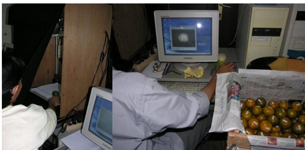
Gambar 2. Proses akuisisi citra buah jeruk menggunakan komputer dan kamera CCD
