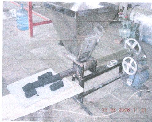
Gambar 3. Pengempa briket mekanis
