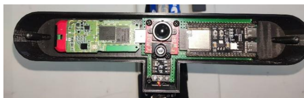
Gambar 24 Kepala Casing Sistem Berisi Sensor, Modem, dan Mikrokontroler
