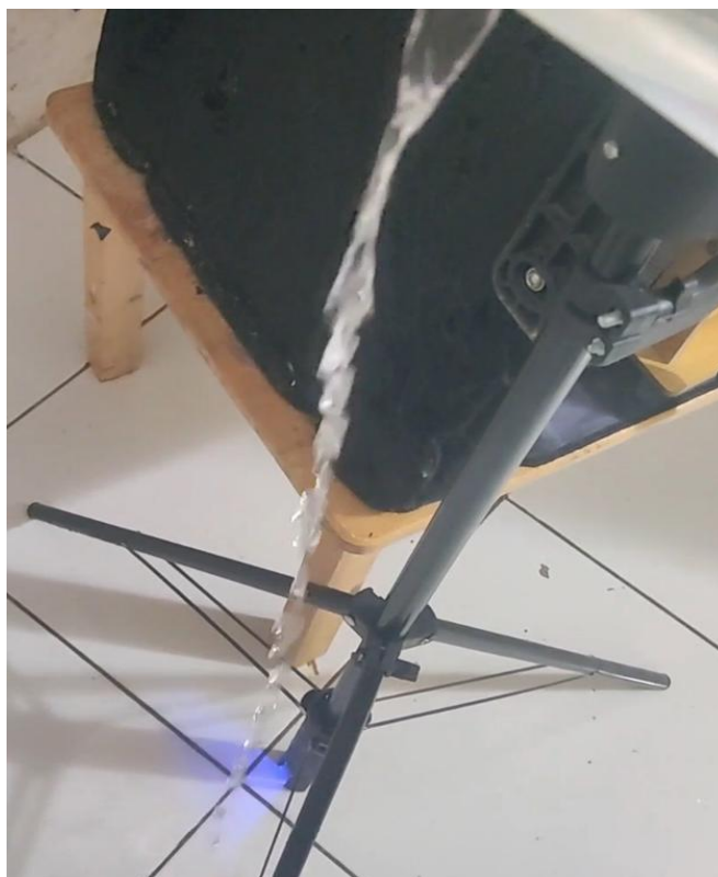
Gambar 36 Pengujian Menuangkan Air Disekitar Water Level Sensor
