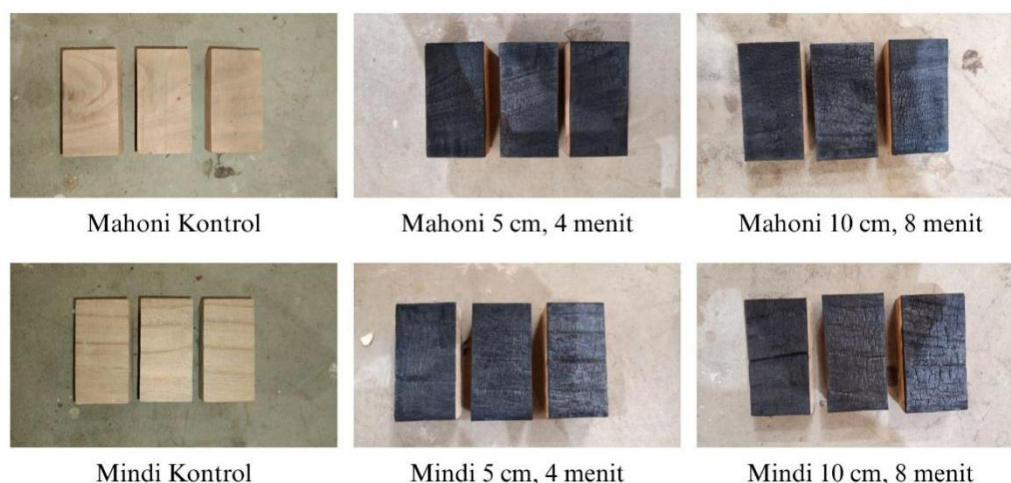
Gambar 1 Perbandingan visual permukaan kayu sampel kontrol dan termodifikasi shou-sugi ban pada berbagai variasi lama waktu dan jarak pembakaran kayu mahoni dan mindi
