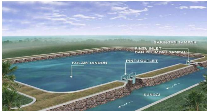
Gambar 31 Kolam retensi tipe di samping badan sungai
