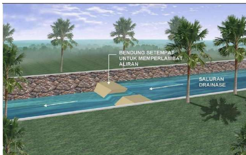
Gambar 33 Kolam retensi tipe storage memanjang
