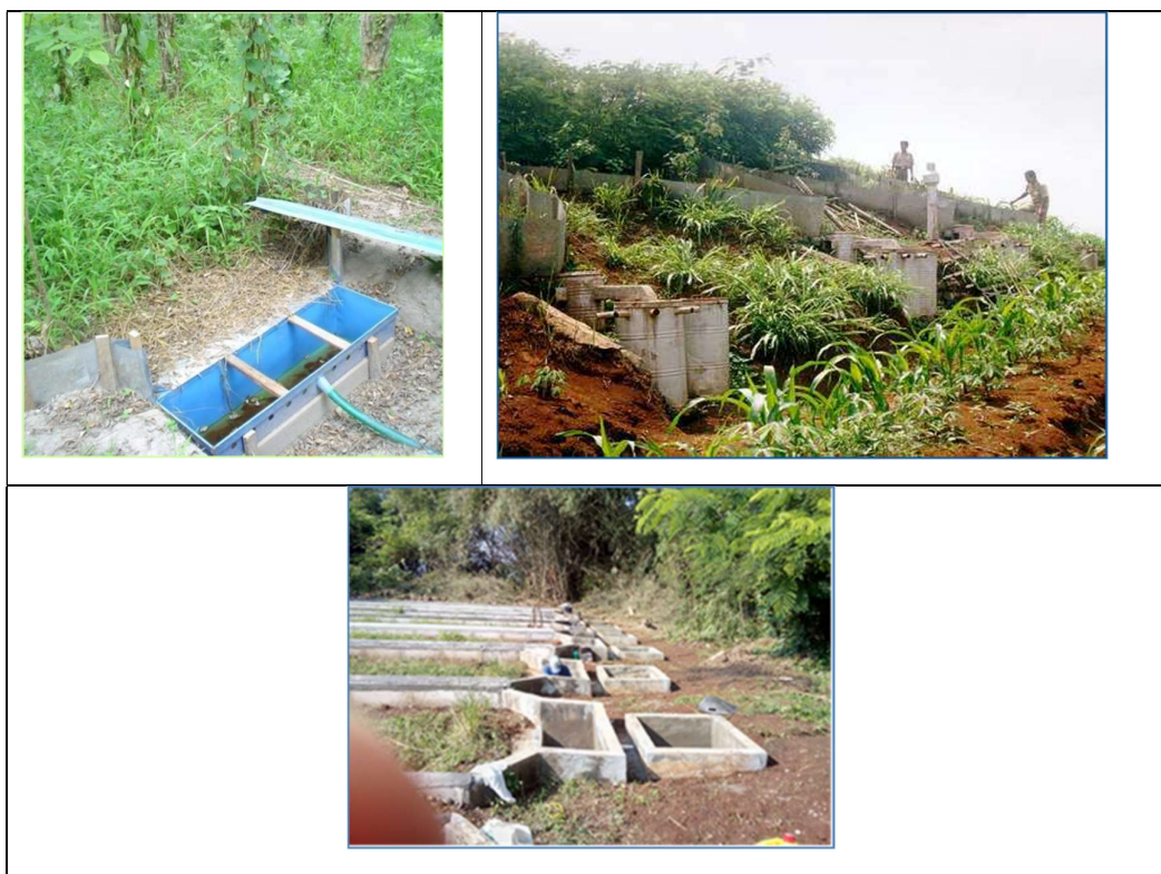
Gambar 22. Contoh petak erosi. Besaran aliran permukaan dan erosi diperoleh dengan mengukur volume air dan jumlah sedimen yang masuk ke bak erosi yang ditempatkan di bagian bawah petak erosi
