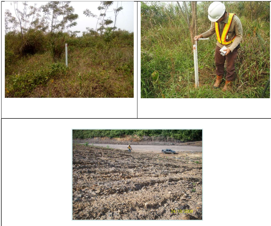
Gambar 23. Penetapan erosi dengan patok ukur erosi dengan mengukur tingginya secara periodik untuk mendapatkan besaran erosi yang terjadi (atas). Variasi erosi lokal yang (bawah)
