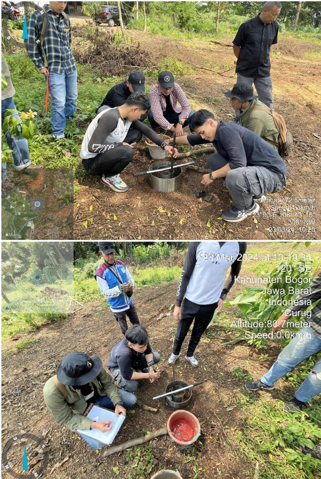
Gambar 22 Pengukuran laju infiltrasi titik 3
