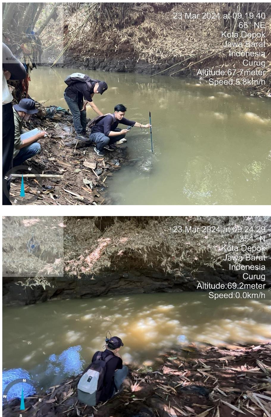
Gambar 19 Pengukuran kecepatan aliran sungai
