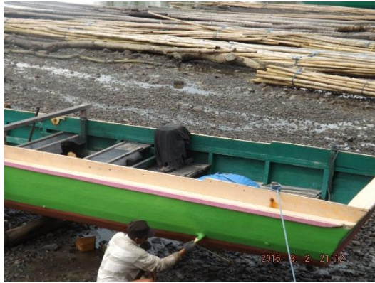
Perbaikan kapal nelayan bagan
