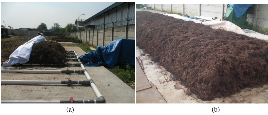
Gambar 20. Pengolahan kompos limbah sawit menggunakan metode aerasi: (a) komponen aerator, (b) kompos limbah sawit.
