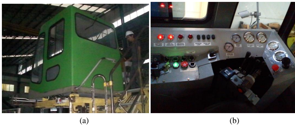
Gambar 29. Kabin : (a) tampak belakang, (b) dashboard dan panel – panel kendali
