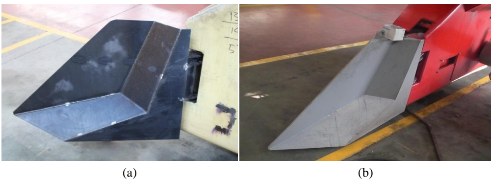
Gambar 27. Plow : (a) sebelum dilakukan proses assembly , (b) setelah terpasang pada unit CT
