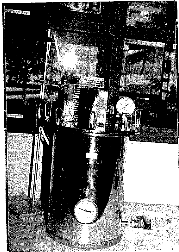
Gambar 11. Bioreaktor baja tahan karat volume 20 liter yang digunakan untuk hidrolisis TKKS.
