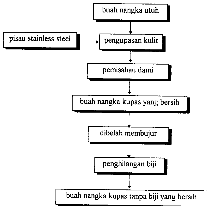
Gambar 2a. Bagan alir pengolahan minimal buah nangka (Champ et al. , 1993)
