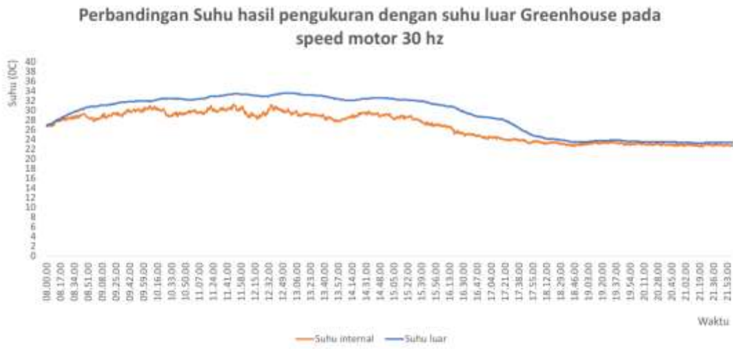
Gambar 13. Perbandingan suhu udara di dalam greenhouse dan suhu udara di luar greenhouse pada kecepatan exhaust fan 30 hertz.
