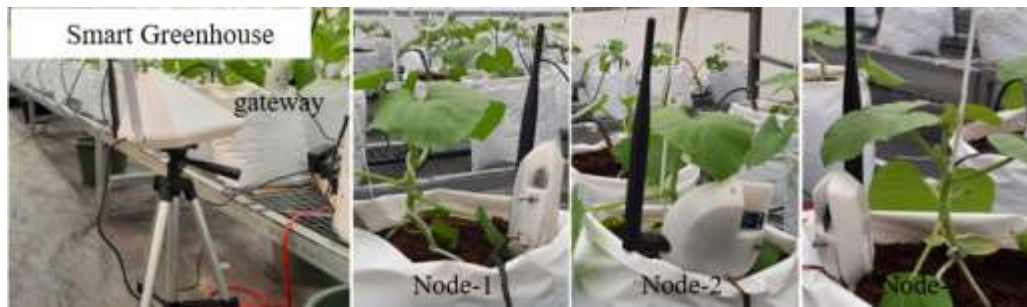
Gambar 22. Instalasi node dan gateway di dalam greenhouse
