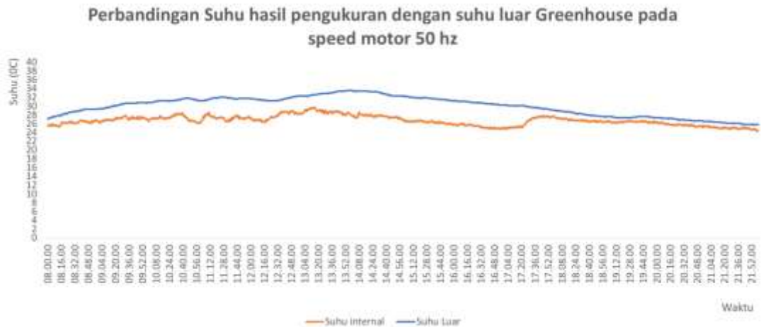
Gambar 15. Perbandingan suhu udara di dalam greenhouse dan suhu udara di luar greenhouse pada kecepatan exhaust fan 50 hertz.
