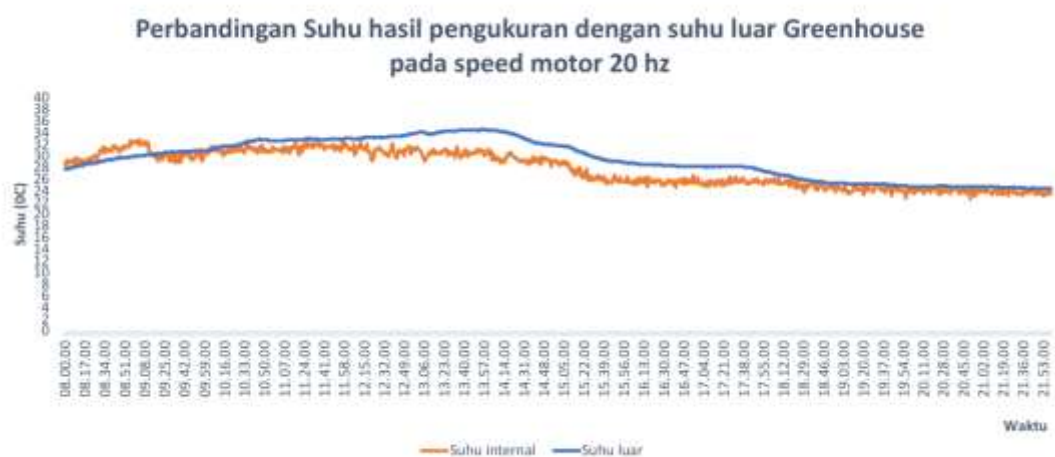
Gambar 12. Perbandingan suhu udara di dalam greenhouse dan suhu udara di luar greenhouse pada kecepatan exhaust fan 20 hertz.
