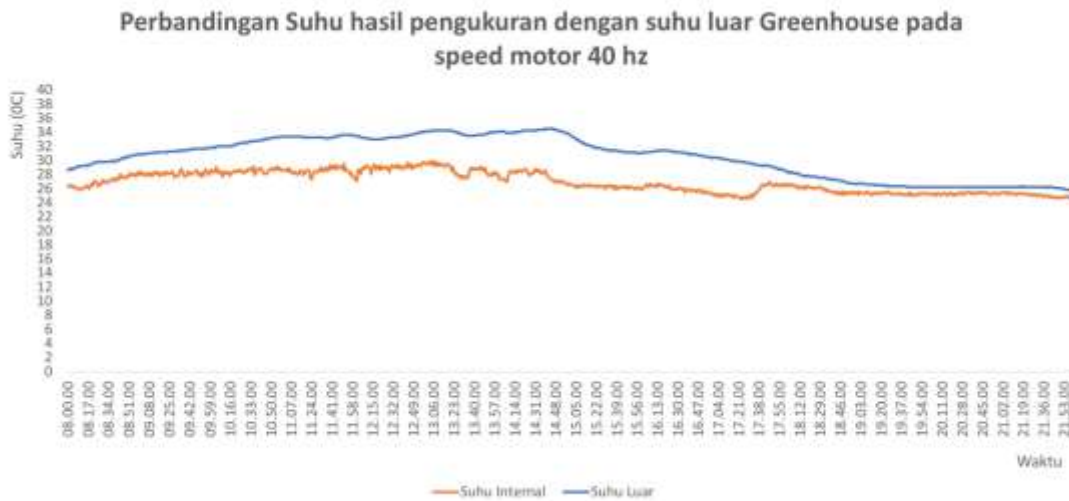
Gambar 14. Perbandingan suhu udara di dalam greenhouse dan suhu udara di luar greenhouse pada kecepatan exhaust fan 40 hertz.
