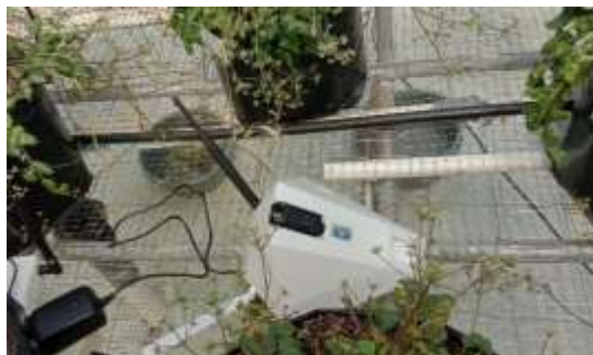
Gambar 32. Perangkat gateway , pada saat diujicobakan di greenhouse .
