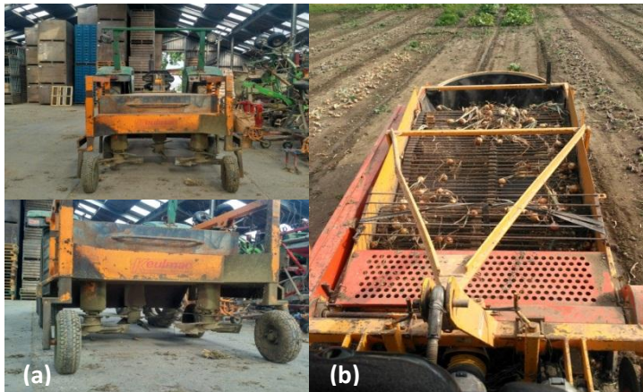
Gambar 10 Mesin pemotong daun (a), mesin panen dan sortir (b)
