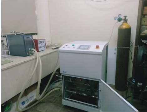
1. Alat Generator untuk produksi air Ultrafine Bubbles di Laboratorium Teknologi Biosistem lingkungan
