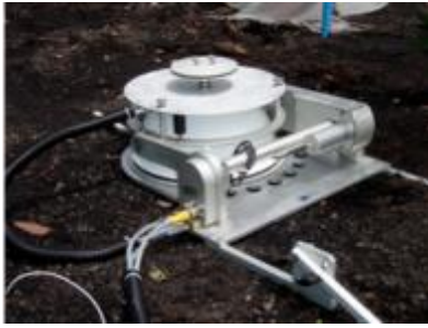
Gambar 2. Alat pengukur emisi CO 2 tanah (LiCor 8100)
