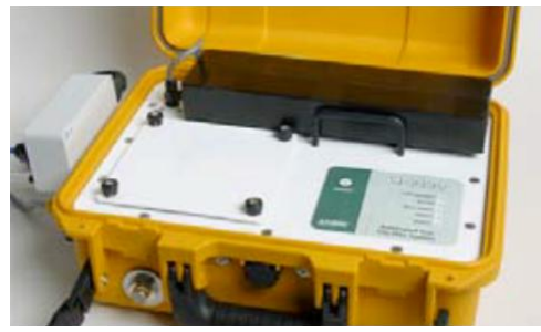
Gambar 2. Alat pengukur emisi CO 2 tanah (LiCor 8100)
