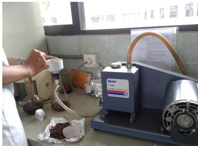
Gambar 5. Proses penyaringan maserat dengan pompa vakum
