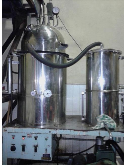
Gambar 7. Proses pembuatan ekstrak akuades sarang semut putih dengan *rotatory evaporator*
