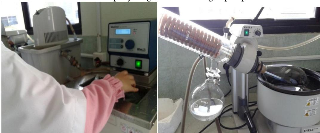
Gambar 6. Proses pembuatan ekstrak etanol 70% dan 96% sarang semut putih dengan *rotatory evaporator*
