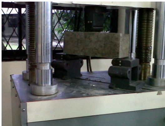
Gambar 3. Uji Lentur Beton
