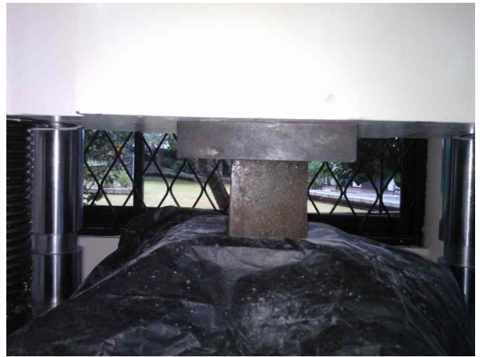
Gambar 2. Uji Tekan Beton
