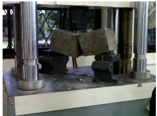
Gambar 4. Uji Lentur Beton
