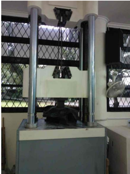
Gambar 1. Uji Tekan Beton
