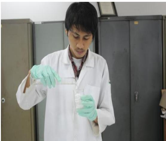
Pencampuran *Styrofoam* dengan Minyak Atsiri
