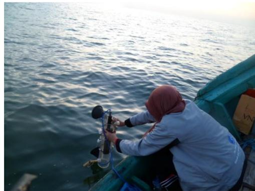
Gambar Proses Pengambilan sampel air
