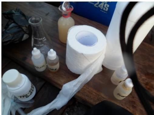
Gambar Peralatan Uji DO secara Insitu
