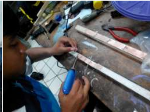
Merekatkan dioda pada PCB dengan solder
