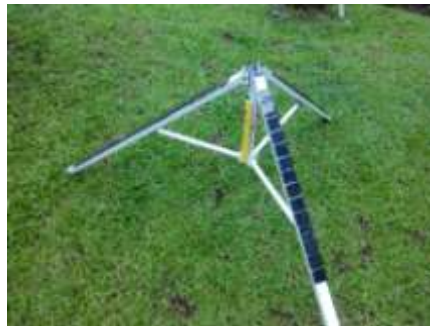
Gambar 10 Pemasangan solar cell pada kaki PWS
