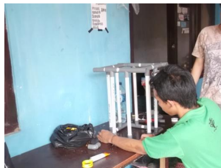
Perakitan pipa penopang galon
