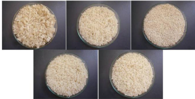
Gambar 3 Penampakan beras analog , dengan teknologi ekstrusi dengan berbagai kadar air dan suhu proses
