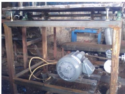
Gambar 2. Penampakan penggerak utama dan sistem transmisi (sebelum direvisi)
