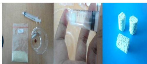
Gambar 2 Pembuatan komposit HAp-Biopolimer dengan metode slow suction
