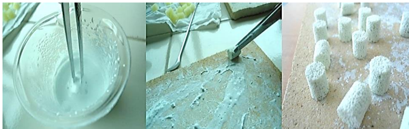
Gambar 1 Pembuatan HAp berpori dengan metode impregnasi spons
