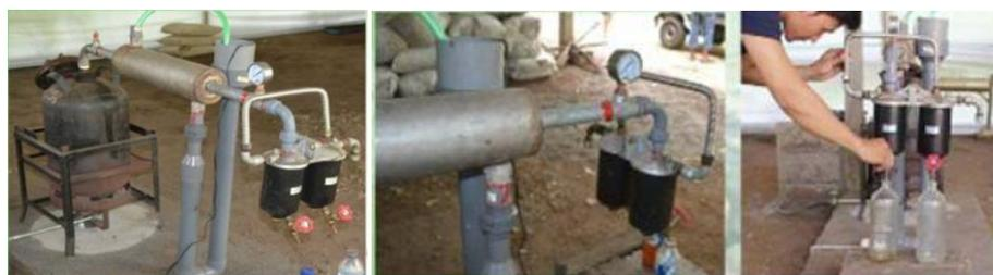
Gambar 5 Reaktor Pirolisis GPP
