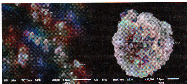
Gambar 2 Nanomagnetit dengan perbesaran 50000x (kiri) dan nanomagnetit teraglomerasi (kanan).
