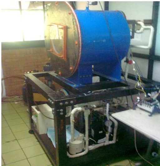
Gambar 4. Mesin pengeringan beku vakum Siklus refrigerasi tunggal
