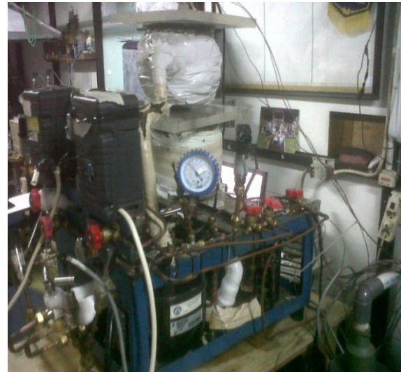
Gambar 5. Mesin pengeringan beku vakum siklus refrigerasi ganda (Cascade)
