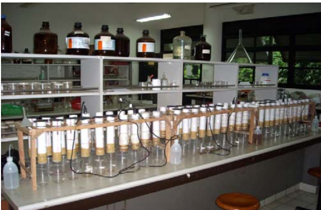
Gambar 1. Pelindian bahan tanah pada beberapa kondisi Eh menggunakan air gambut, payau, dan hujan
