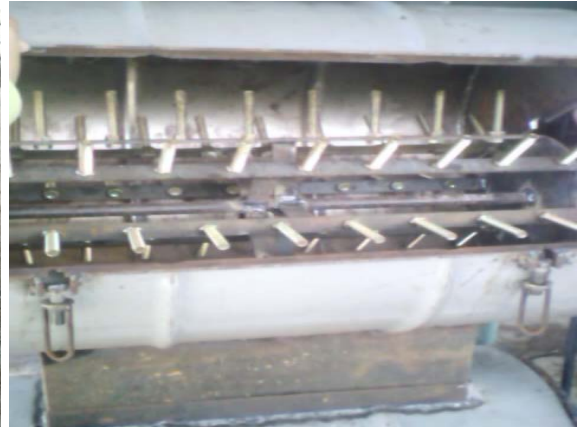
Gambar 4. Konstruksi chopper menggunakan rectangular blades (kiri) dan bolts (kanan)
