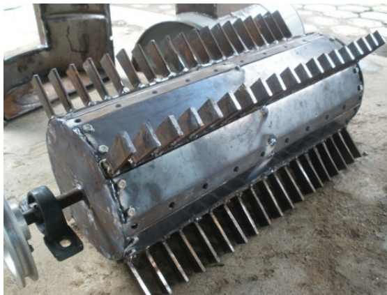
Gambar 4. Konstruksi chopper menggunakan rectangular blades (kiri) dan bolts (kanan)
