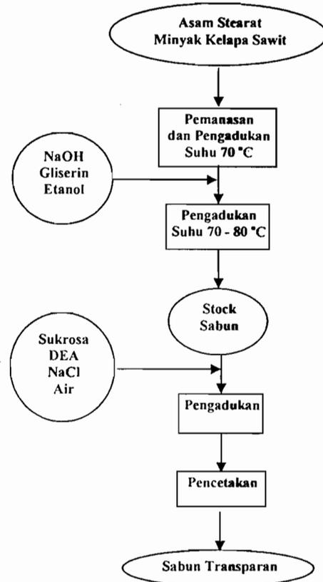
Gambar 1. Diagram alir pembuatan sabun transparan
