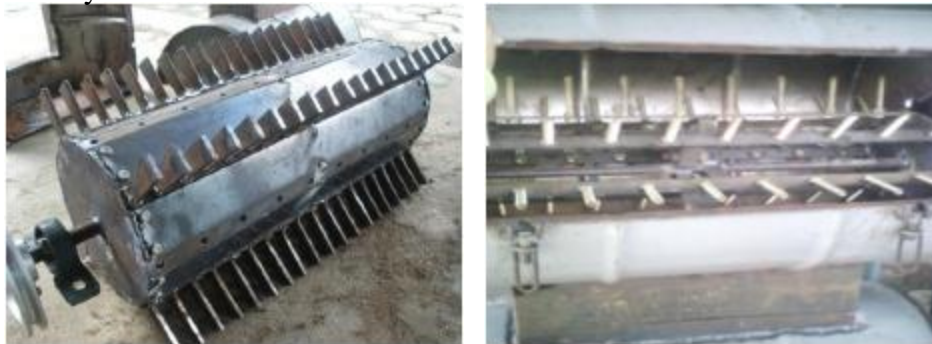
Gambar 2. Dua jenis pisau pencacah yaitu (a) pencacah sampah basah dan (b) pencacah sampah kering.
