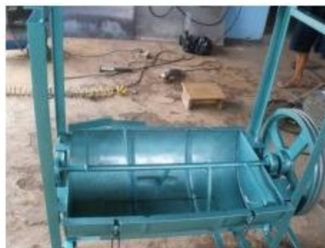
Gambar 3. Bagian pengaduk dan atau penampungan sampah.
