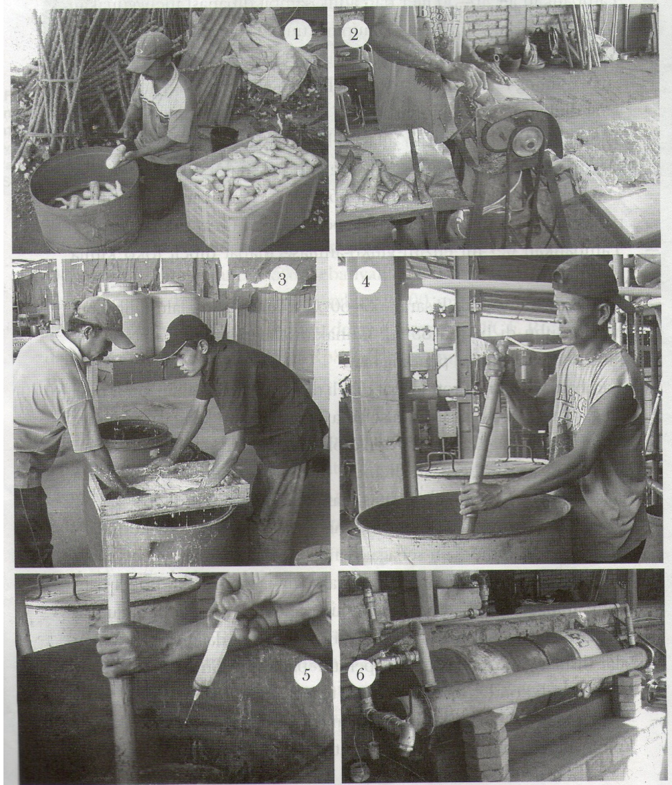
Proses pembuatan bioetanol skala kerakyatan dengan kapasitas 200-400 liter bioetanol perhari 1. Pengupasan umbi, 2. Penggilingan, 3. Penyaringan, 4. Pengadukan bahan sambil dipanaskan, 5. Penambahan enzim, 6. Tangki penampungan dan penukar panas.
