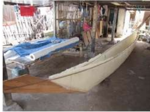
Konstruksi Perahu Ketiting dari fiber
