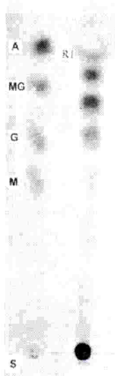
Gambar 1. Kromatogram TLC produk transglukosilasi dengan donor pati dan aseptor resorsinol, maltosa, glukosa, metil- \alpha -glukosida, dan arbutin (S); Maltosa (M); Glukosa (G); Metil- \alpha -glukosida (MG); Arbutin (A); Resorsinol glukosida (R1); Resorsinol glukobiosida (R2). Eluen yang digunakan 1-propanol dan pengembang warna 20% H_2SO_4 dalam metanol.
