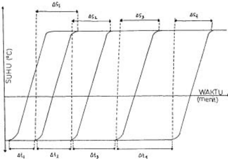
Gambar 7. Skema cara penentuan nilai At dan As
