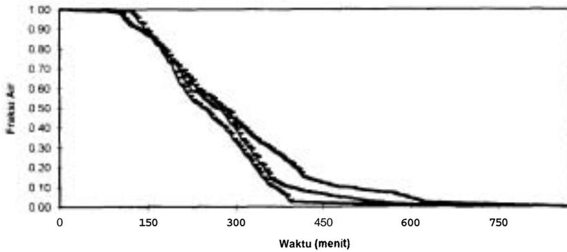
Gambar 5. Grafik penurunan fraksi air pada perlakuan laju pembekuan lambat.
